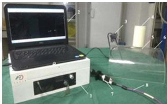
图 13 磁锚定荧光专用腹腔镜实物
