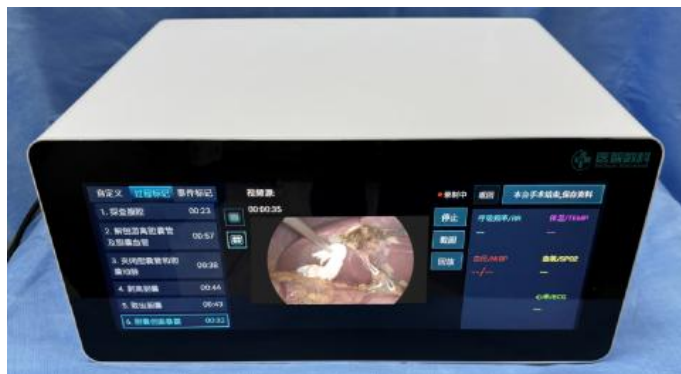
图 5-3 内窥镜影像监测系统使用界面
