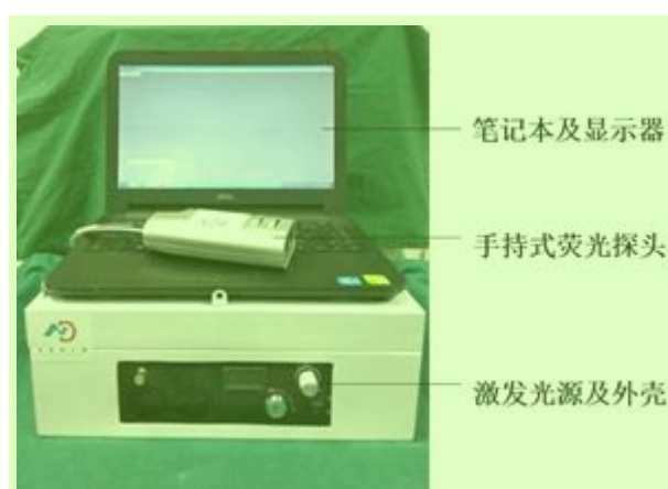
图 12 开放式荧光手术导航系统实物图 7
