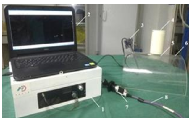
图 13 磁锚定荧光专用腹腔镜实物
